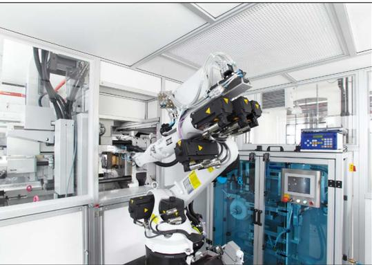
Eine vollelektrische 2K-Spritzgiessmaschine, ein Sechs-Achs-Roboter und eine Verpackungsmaschine befinden sich als Produktionszelle in einer Reinraumbox der Klasse 7. Damit kann Pfaff das Handling und die Verpackung der fertig gespritzten Produkte unter Reinraumbedingungen garantieren.
