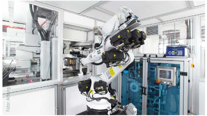
Zelle für Produktion, Handling und Verpackung unter Reinraumbedingungen (Klasse 7) mit vollelektrischer 2K-Spritzgießmaschine und Sechs-Achs-Roboter.
