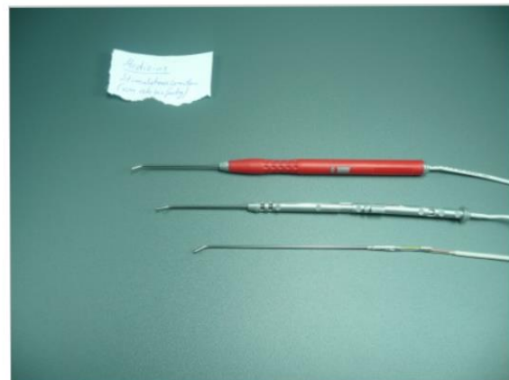
Mit Hilfe der Spritzgießtechnik lässt sich zum Beispiel die Verkleidung von Stimulationssonden herstellen (von unten nach oben vom rohen bis zum fertigen Zustand). (Foto: Pfaff GmbH)
